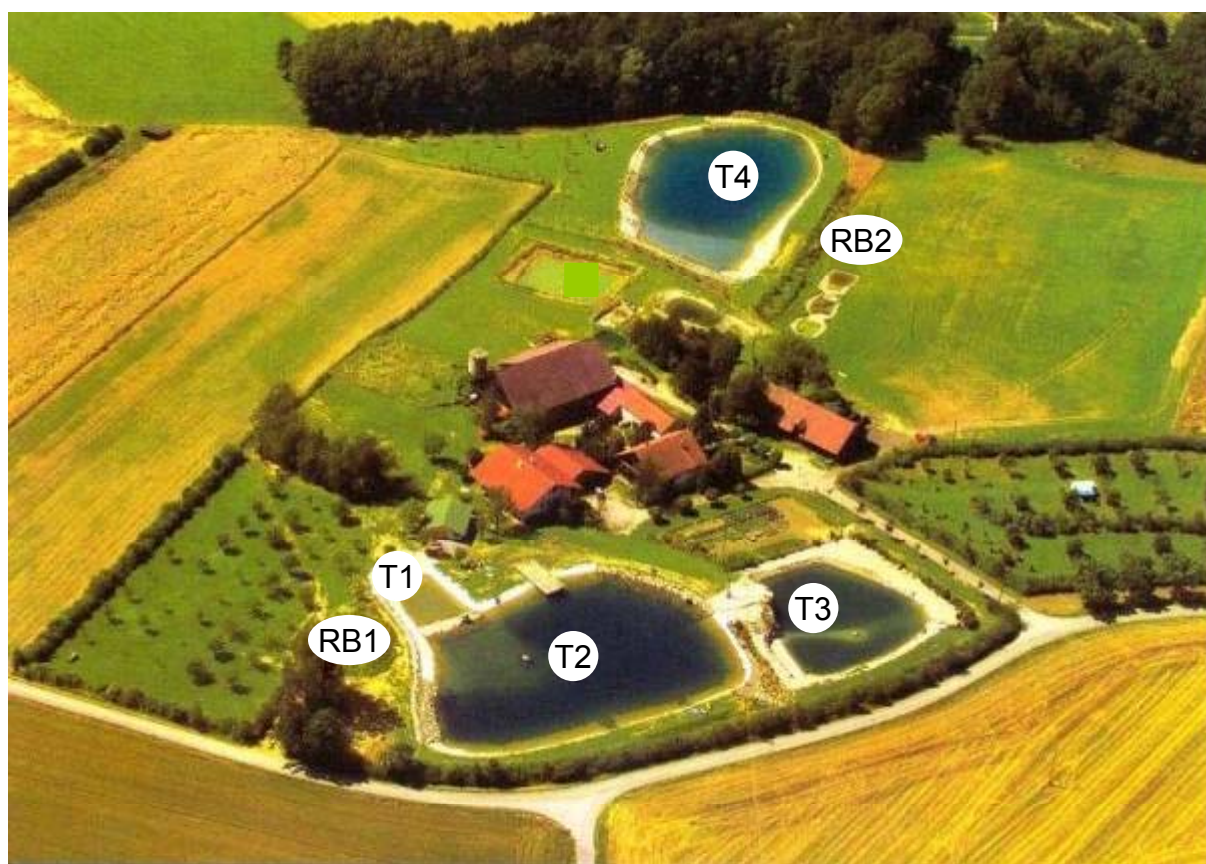
Abb. 1.2.1 Luftbildaufnahme der gesamten Schwimmteichanlage mit den Teichen T1 bis T4 und Retentionsbecken 1 (RB1) im oberen Teil sowie Retentionsbecken 2 (RB2) im unteren Teil der Schwimmteichanlage (Stand: Juli 2005). In die quantitativen Untersuchungen wurden die Teiche T2 und T3 sowie die Kaskade der Retentionsbecken RB2 (Zulauf und Ablauf) einbezogen, RB1 nur qualitativ beprobt. Detailfotos zu den Teichen 1 und 2 siehe Abb. 1.2.2., zu den Retentionsbecken 1 und 2 Abb. 2.1.1. und 2.2.4.1.
